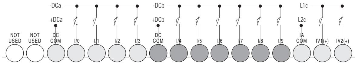
**1763-L16AWA and 1763-L16BWA Output Wiring Diagram**
